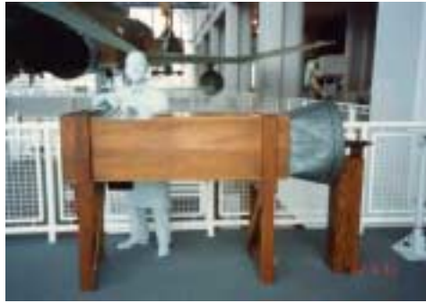
図4 ライト兄弟の風洞のレプリカ（ハンプトン航空宇宙博物館）
