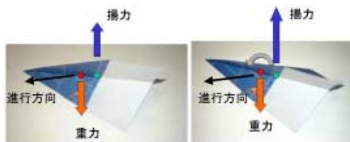
図5 頭を上げた紙飛行機は増加する揚力によってもとにもどる力が発生する
