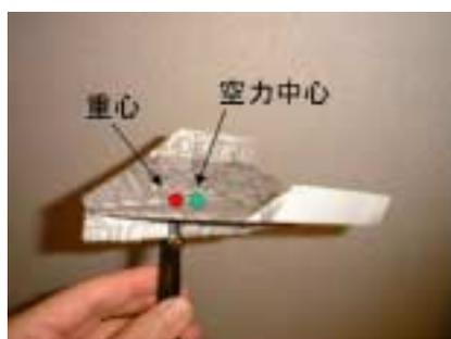
図4 良く飛ぶ紙飛行機の重心と空力中心の位置関係
