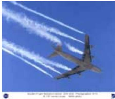
図7 ジャンボジェットが作る翼端渦（資料：NASA）
